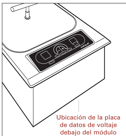
Ubicación de la placa de voltaje
